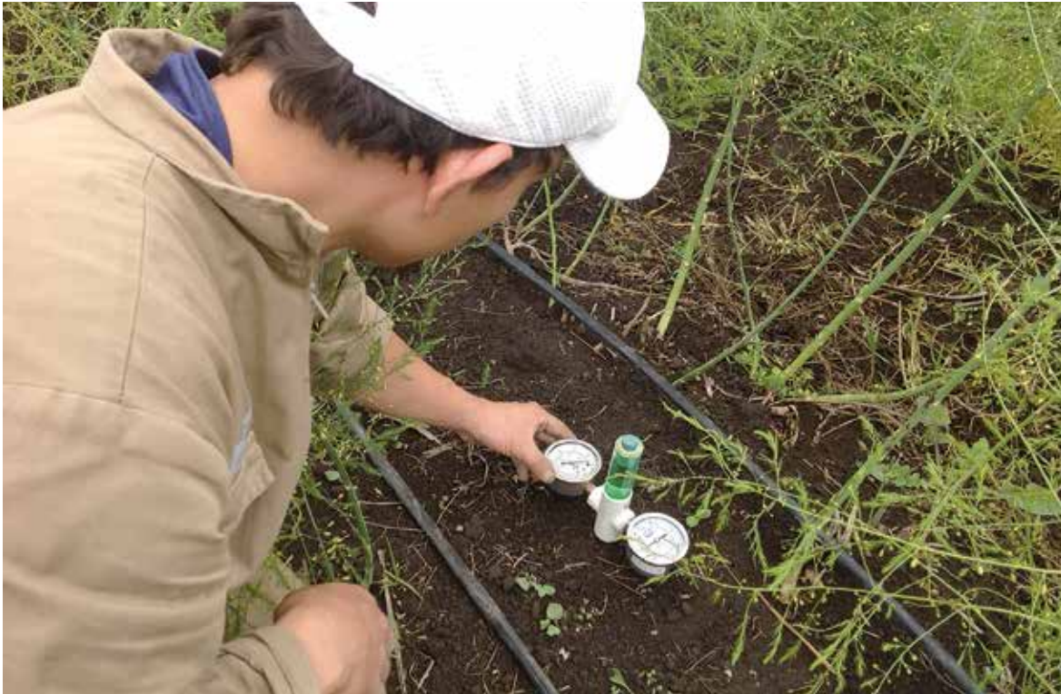
Tensiómetro para suelos agrícolas, patente de la Universidad Nacional de Colombia.
